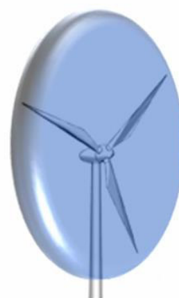
Risikobereich (Zylinder mit Radius der Rotorblattlänge und Tiefe der maximalen Rotorblatttiefe plus Körpergröße des Vogels)
